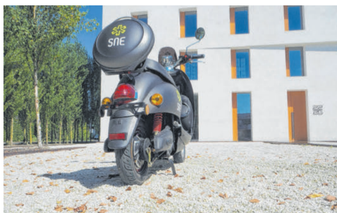
Der Motor des „Lustenauer“ SNE-Elektroscooters, der seit wenigen Tagen auf dem Markt ist, befindet sich im Hinterrad.
